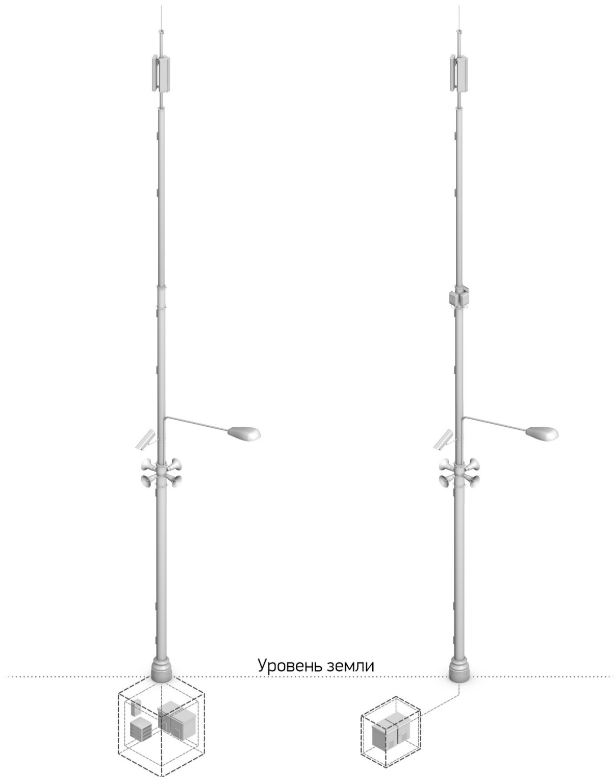
Рис. 14 Размещение части оборудования вне ОДН в колодцах или других сооружениях, расположенных ниже уровня земли
